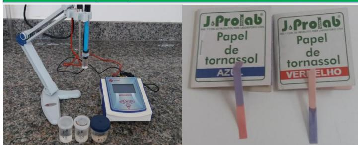
Pode-se observar que o pH do sabão comercial é inferior somente a amostra 1 e a amostra 4, respectivamente. As demais amostras apresentaram valores inferiores em relação ao comercial com diferenças mínimas entre elas, testadas nos três tipos de equipamentos. De acordo com esse teste, as formulações de sabão caseiro 1 e 4 são mais alcalinas que o sabão comercial, e por essa razão apresentam potencial para causar danos a saúde dos usuários por excesso de alcalinidade.
