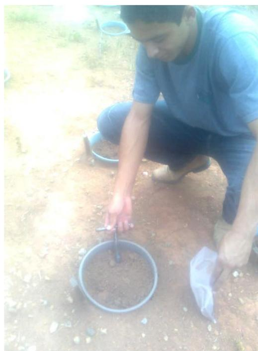
Figura 4 - Detalhe da coleta das amostras nos tratamentos com incorporação dos resíduos orgânicos utilizando-se sonda com comprimento de 40 cm.
