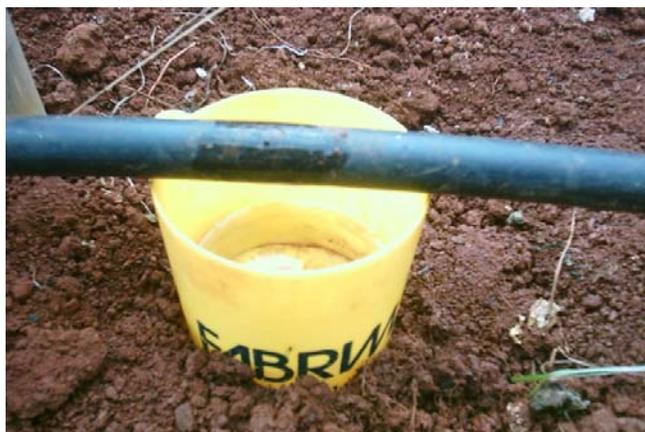
**FIGURA 21** Detalhe da realização do teste final de uniformidade de emissão de água após a retirada das plantas.
