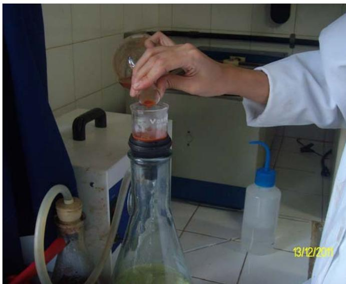
Figura 3 Bomba de vácuo para filtração do material precipitado com formaldeído
