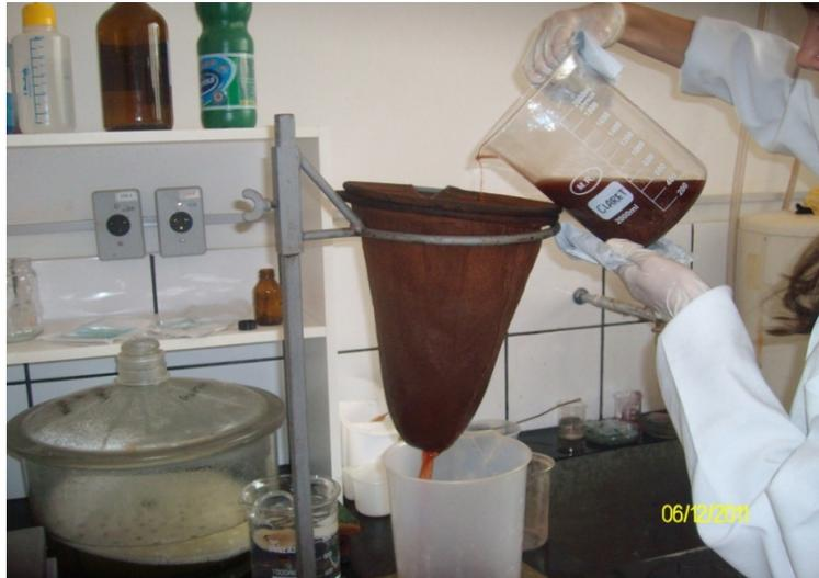
Figura 1 Filtragem do extrato utilizando-se tecido de flanela
