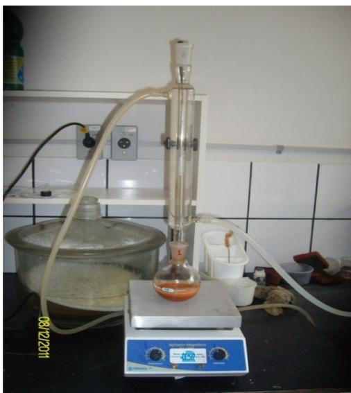
Figura 2 Chapa de aquecimento sob refluxo
