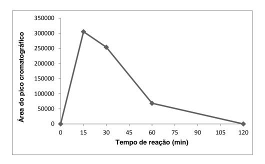
Figura 30: Área do pico cromatográfico do íon [1b − H] de *m/z* 234,9705 em função do tempo de reação de degradação do corante IC pelo sistema RPC5/Zn/H<sub>2</sub>O<sub>2</sub>.
