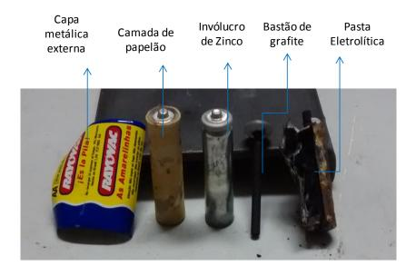
Figura 10: Foto das pilhas desmanteladas.
