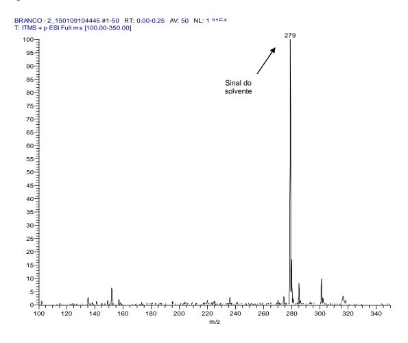
Figura 39: Espectro de massas do solvente usado nas reações de degradação redutiva.
