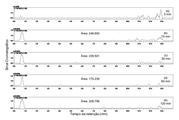
Figura 27: Cromatogramas de íon extraído de [1e – H] m/z 118,9425 para os tempos de reação de (a) 0 min, (b) 15 min, (c) 30 min, (d) 60 min, (e) 120 min de degradação do IC pelo sistema RPC5/Zn/H<sub>2</sub>O<sub>2</sub>.
