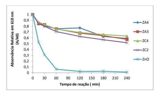
Figura 48: Absorvância relativa em 610 nm em função do tempo de reação para os ensaios de fotocatálise.
