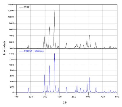
Figura 11: Difratogramas de raios-x do material RPC5 (a) e do mineral hetaerolita (b), de fórmula química ZnMn₂O₄.
