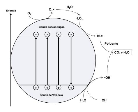
Figura 9: Mecanismo geral da fotocatálise usando um semi-condutor (adaptado [82]).
