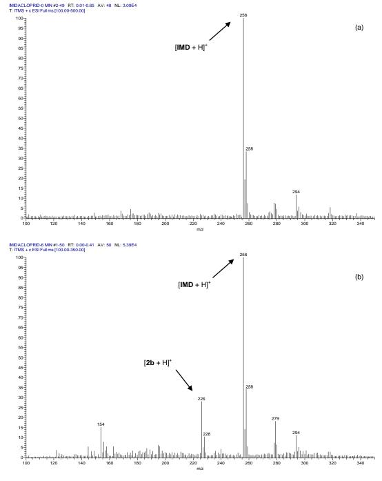
Figura 36: Espectros de massas das amostras recolhidas nos tempos de reação (a) 0 min e (b) 6 min de degradação redutiva (pH 3 e 20 mg de Zn<sup>0</sup>) do IMD sem controle de pH.
