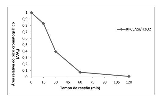
Figura 25: Área relativa do pico cromatográfico do íon [IC – 2H]<sup>2-</sup> de *m/z* 209,9829 em função do tempo de reação de degradação do corante IC pelo sistema RPC5/Zn/H<sub>2</sub>O<sub>2</sub>.
