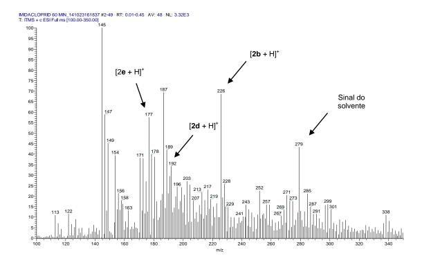
Figura 41: Espectros de massas da alíquota retirada após 60 minutos de degradação redutiva (pH 3 e 20 mg de Zn<sup>0</sup>) do IMD com controle de pH.
