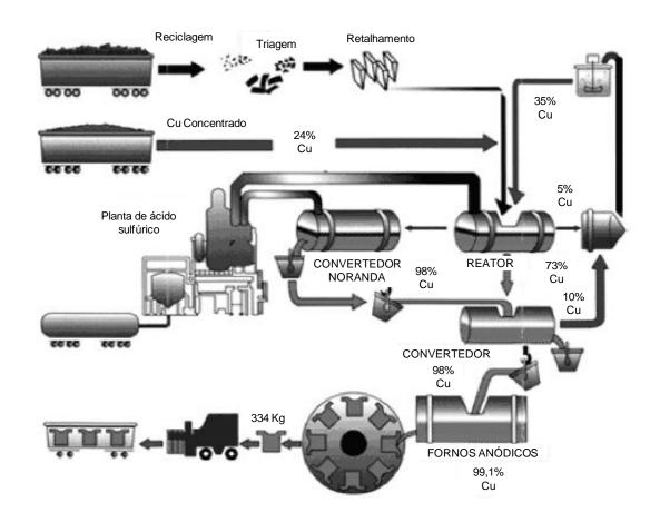
Figura 2: Etapas de recuperação de cobre pelo processo Noranda [26].
