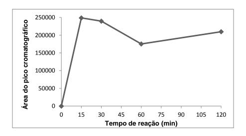
Figura 28: Área do pico cromatográfico do íon [1e − H] de *m/z* 118,9425 em função do tempo na reação de degradação do corante IC pelo sistema RPC5/Zn/H<sub>2</sub>O<sub>2</sub>.
