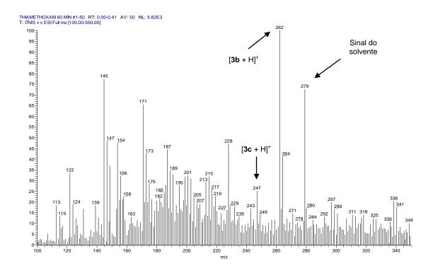
Figura 44: Espectro de massas da alíquota retirada após 60 minutos de degradação redutiva (pH 3 e 20 mg de Zn<sup>0</sup>) do TMT com controle de pH.
