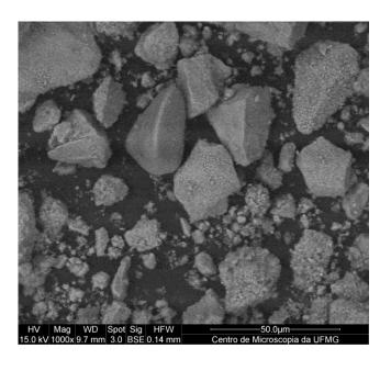
Figura 12: Imagem do material RPC5 por microscopia eletrônica de varredura (MEV).
