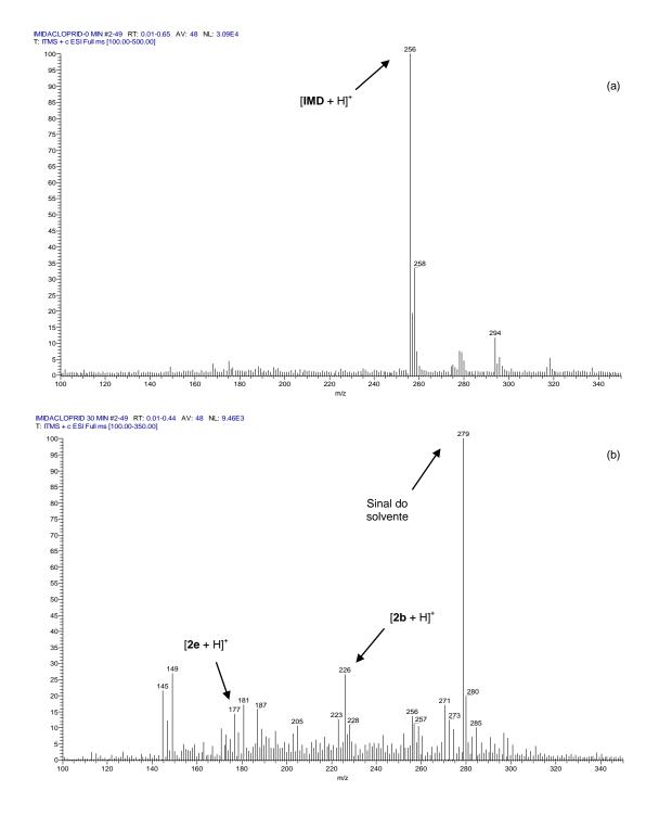
Figura 38: Espectros de massas das alíquotas retiradas nos tempos de reação (a) 0 min e (b) 30 min de degradação redutiva (pH 3 e 20 mg de Zn<sup>0</sup>) do IMD com controle de pH.
