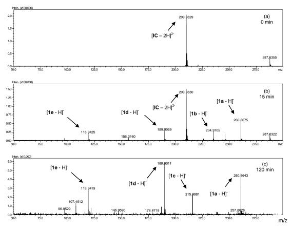
Figura 26: Espectros de massas das amostras recolhidas nos tempos de reação de, (a) 0 min, (b) 15 min e (c) 120 min na degradação do IC pelo sistema RPC5/Zn/H<sub>2</sub>O<sub>2</sub>.
