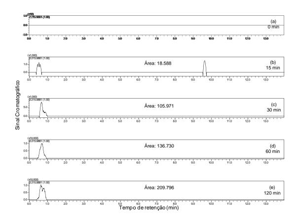
Figura 31: Cromatogramas de íon extraído de [1c - H] m/z 215,9881 para tempos de reação de (a) 0 min (b) 15 min (c) 30 min (d) 60 min (e) 120 min de degradação do IC pelo sistema RPC5/Zn/H<sub>2</sub>O<sub>2</sub>.
