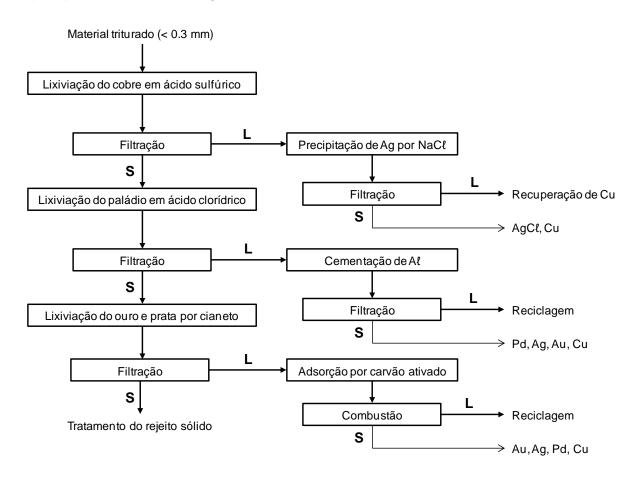
Figura 3: Exemplo de processo hidrometalúrgico de recuperação de metais [26].
