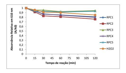
Figura 18: Absorvância relativa (A/A<sub>0</sub>) da solução do corante IC em função do tempo de reação nos ensaios de adsorção (50 mg de catalisador) e degradação por H<sub>2</sub>O<sub>2</sub> (0,5 mL).
