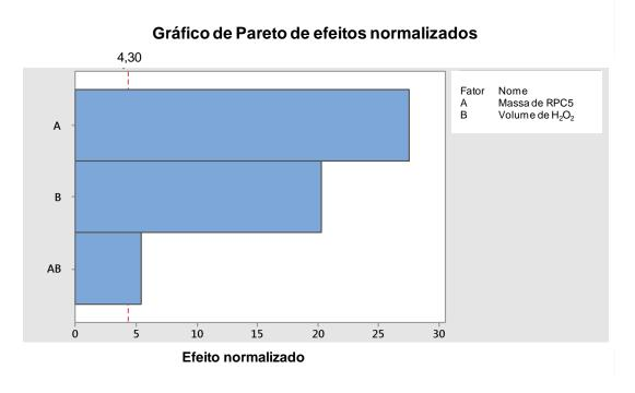
Figura 19: Gráfico de Pareto para os fatores massa de catalisador RPC5 e volume de H<sub>2</sub>O<sub>2</sub> avaliados na degradação do corante IC pelo catalisador RPC5.
