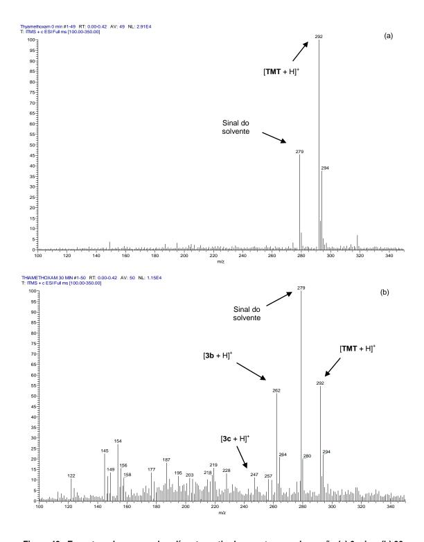
Figura 42: Espectros de massas das alíquotas retiradas nos tempos de reação (a) 0 min e (b) 30 min de degradação redutiva (pH 3 e 20 mg de Zn<sup>0</sup>) do TMT com controle de pH.
