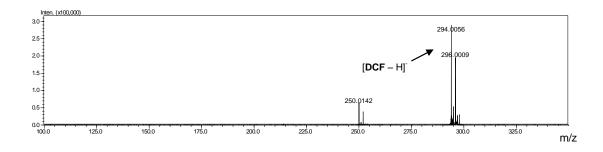
Figura 34: Espectro de massas da amostra inicial da reação de degradação do DCF pelo sistema Zn/H<sub>2</sub>O<sub>2</sub>.
