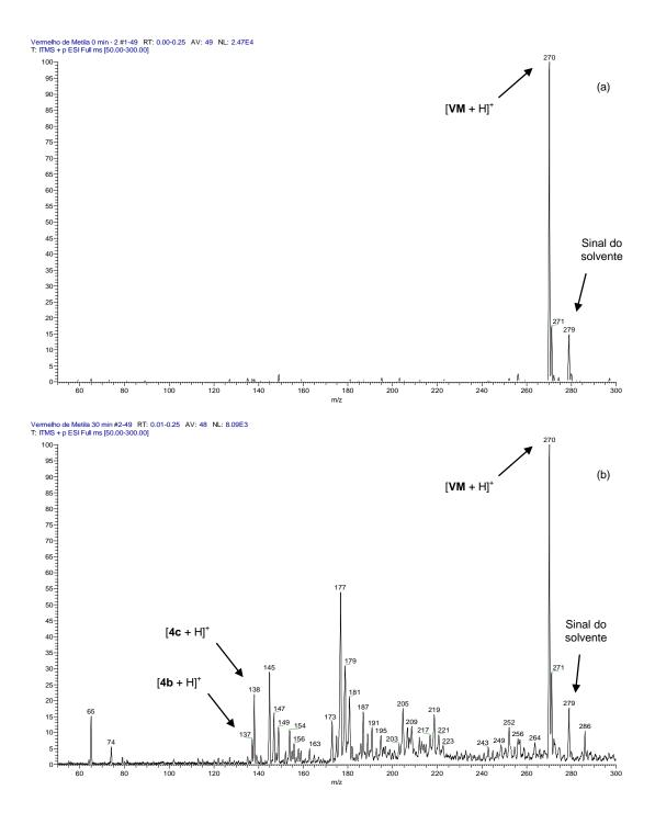
Figura 45: Espectros de massas da solução inicial (a) e da alíquota retirada após 30 minutos (b) de reação de degradação redutiva (pH 3 e 20 mg de Zn<sup>0</sup>) do VM com controle de pH.
