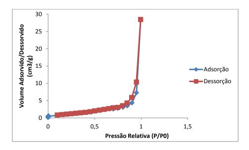
Figura 16: Isoterma de adsorção/dessorção para o material RPC5.
