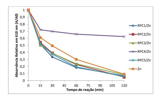
Figura 21: Degradação do corante IC em sistema Fenton-*like* com adição de 10 mg de Zn metálico obtido das pilhas à 50 mg dos catalisadores RPC1 a RPC5.
