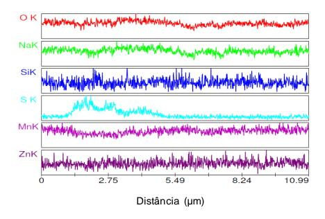
Figura 13: Mapa de linha para RPC5 obtido pela espectroscopia de energia difusa (EDS).
