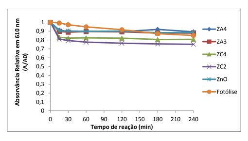
Figura 49: Absorvância relativa em 610 nm em função do tempo de reação para os ensaios de adsorção e fotólise.
