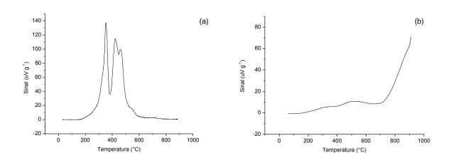
Figura 15: Curvas TPR para (a) MnO<sub>2</sub> (material comercial) e (b) ZnO (material comercial) obtidas pela técnica de redução à temperatura programada.
