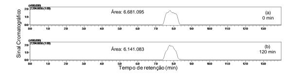
Figura 35: Cromatogramas de íon extraído do [DCF – H] $^{-}$  de m/z 294,0056 / 296,0009 para os tempos de reação (a) 0 min e (b) 120 min de degradação do DCF no sistema Zn/H $_2$ O $_2$ ..
