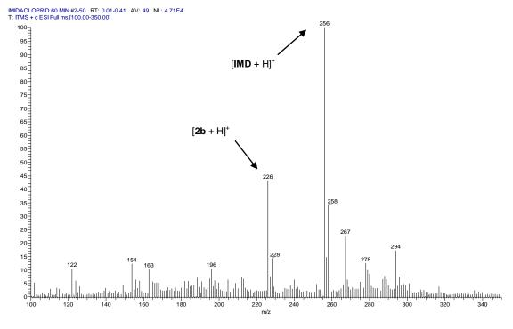
Figura 37: Espectro de massas da amostra recolhida no tempo de reação 60 min de degradação redutiva (pH 3 e 20 mg de Zn<sup>0</sup>) do IMD sem controle de pH.
