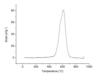
Figura 14: Curva TPR para o material RPC5 obtida pela técnica de redução à temperatura programada.
