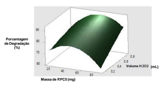
Figura 20: Superfície de resposta do planejamento fatorial estrela realizado para a otimização das condições (massa de catalisador e volume de H<sub>2</sub>O<sub>2</sub>) de degradação do IC pelo catalisador RPC5.
