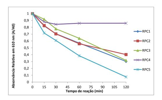
Figura 17: Absorvância relativa (A/A<sub>0</sub>) da solução do IC em função do tempo de reação nos ensaios de degradação dos sistemas Fenton-*like* (50 mg de catalisador e 0,5 mL de H<sub>2</sub>O<sub>2</sub>).
