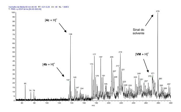
Figura 47: Espectro de massas da alíquota retirada após 60 minutos de degradação redutiva (pH 3 e 20 mg de Zn<sup>0</sup>) do VM com controle de pH.
