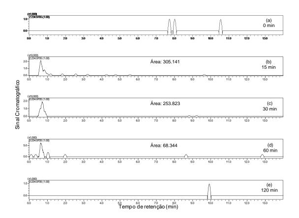
Figura 29: Cromatogramas de íon extraído de [1b - H] m/z 234,9705 para tempos de reação de (a) 0 min, (b) 15 min, (c) 30 min, (d) 60 min, (e) 120 min de degradação do IC pelo sistema RPC5/Zn/H<sub>2</sub>O<sub>2</sub>.
