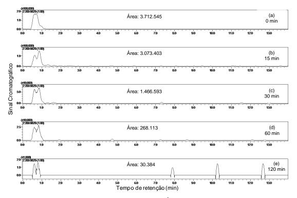
Figura 24: Cromatogramas de íon extraído de [IC – 2H]<sup>2-</sup> m/z 209,9829 para tempos de reação (a) 0 min, (b) 15 min, (c) 30 min, (d) 60 min, (e) 120 min de degradação do IC pelo sistema RPC5/Zn/H<sub>2</sub>O<sub>2</sub>.
