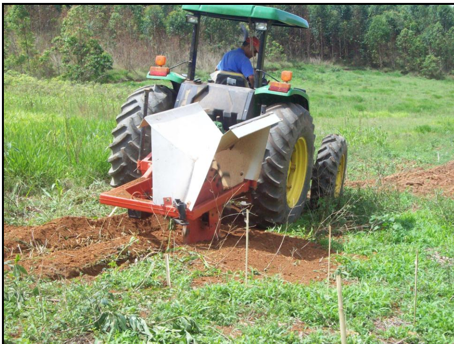
Figura 3 – Abertura dos sulcos de mulching vertical com valetadeira rotativa acoplada à tomada de força do trator em uma das parcelas experimentais. Coimbra – MG, 2009.
