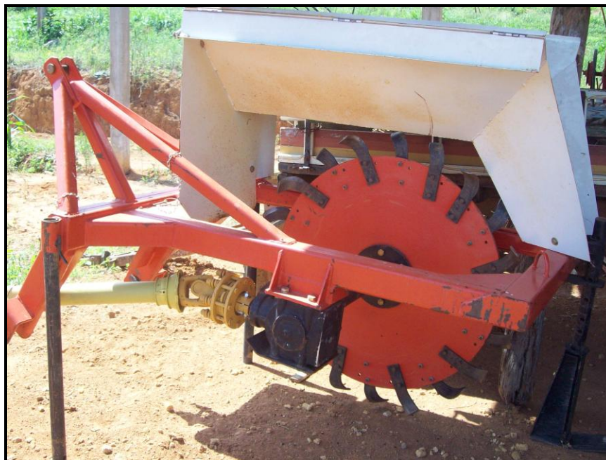
Figura 1 – Valetadeira rotativa empregada na implantação do mulching vertical.
