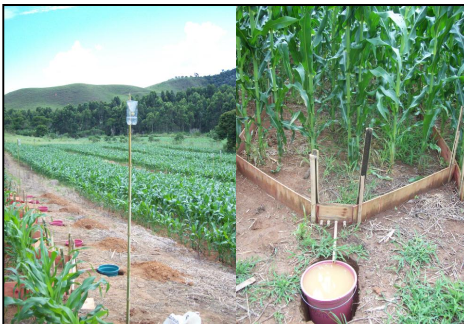
Figura 4 – Coletores de precipitação e escoamento superficial instalados nas parcelas experimentais. Coimbra – MG, 2009.
