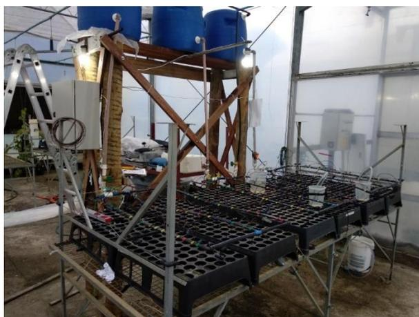
**Figura 1.** Bancada experimental com três sistemas de microirrigação por gotejamento, abastecidos por reservatórios independentes.
