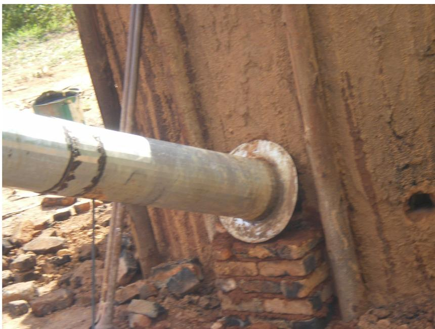
Figura 14 – Detalhe da base do tubo coletor de pirolenhoso acoplado junto à parte inferior do forno rabo quente a 0,50 metros do solo.
