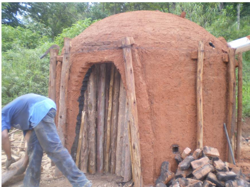
Figura 8 – Enchimento do forno rabo quente com madeira de *Eucalyptus cloeziana* dispostas verticalmente.
