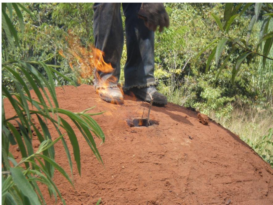
Figura 9 – Ignição do processo de carbonização da madeira no forno rabo quente através de uma das baianas da cúpula.
