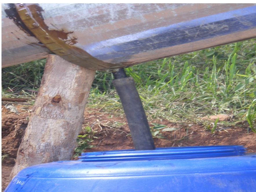
Figura 5 – Detalhe do acoplamento da pingadeira ao interior do recipiente para armazenamento do líquido pirolenhoso.
