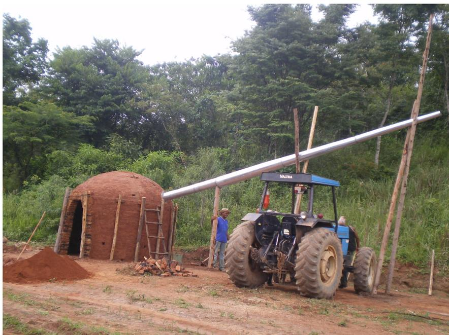
Figura 6 – Tubo coletor de líquido pirolenhoso acoplado a 1,85 metros de altura a aproximadamente  $100^\circ$  em relação ao solo.
