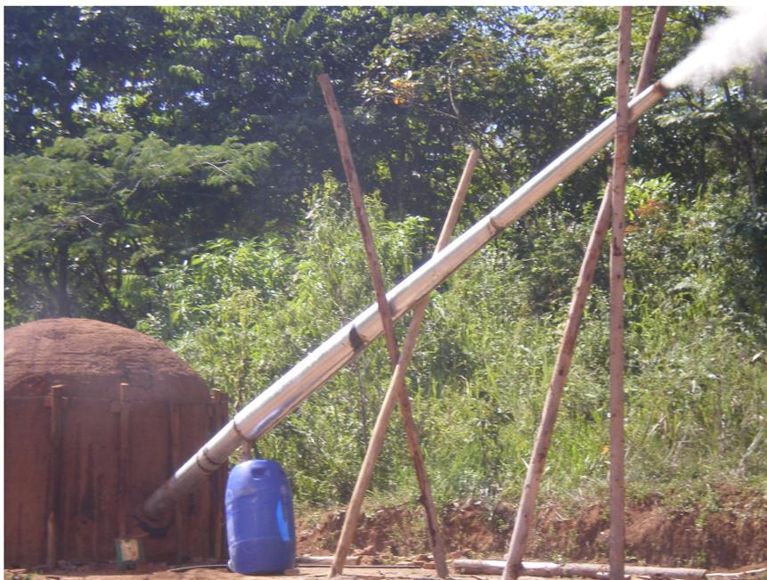
Figura 15 – Tubo coletor acoplado ao forno na parte inferior em processo de coleta dos gases condensáveis.
