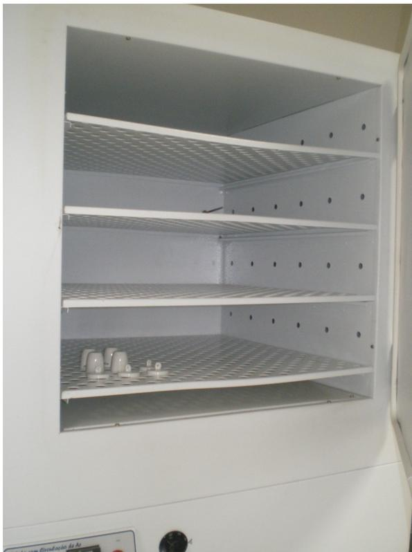
Figura 11 – Interior da estufa de circulação forçada de ar.
