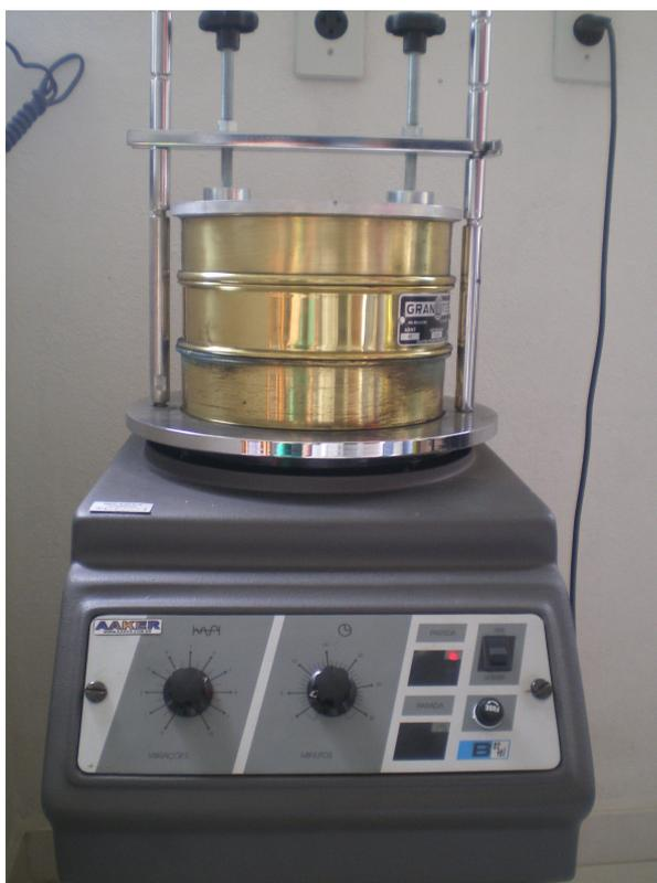
Figura 10 – Agitador elétrico de peneiras granulométrico.
