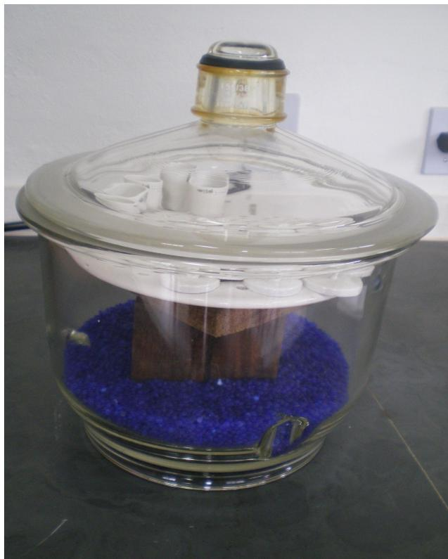
Figura 13 – Dessecador contendo sílica para resfriamento dos cadinhos após passagem pela mufla elétrica.
