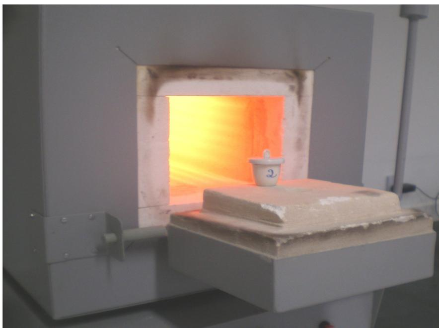
Figura 12 – Cadinho de porcelana contendo amostra de carvão vegetal em mufla elétrica com controle de temperatura digital para determinação de material volátil
