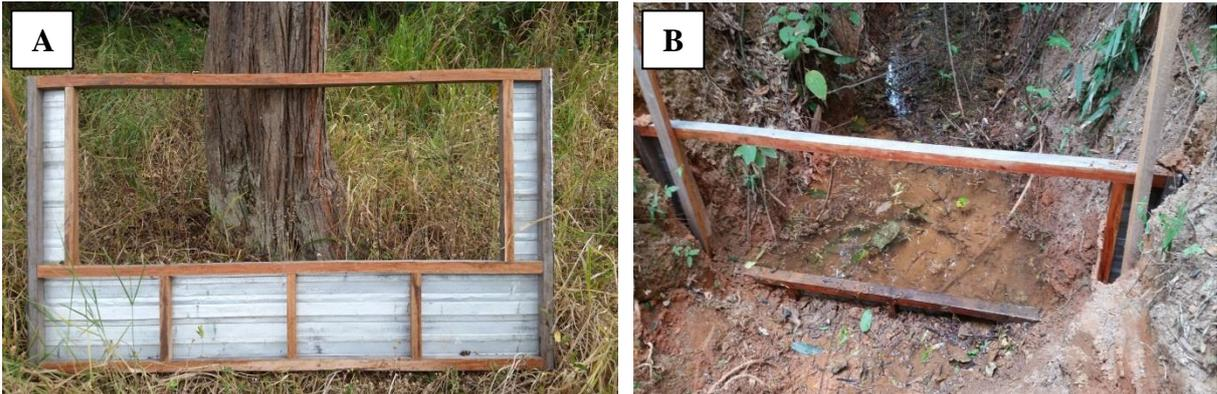
Figura 6 – Vertedouro construído (A) e instalado (B) . Fonte: O autor.
