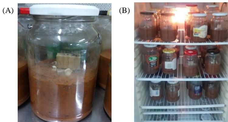
**Figura 4** - (A) Frasco contendo um corpo de prova sobre a placa alimentadora com o fungo. (B) Frascos com o experimento na incubadora. Fonte: Autora (2019).
