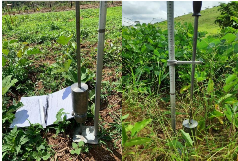
Figura 5 - Medição de resistência do solo a penetração com o Penetrômetro de Impacto
