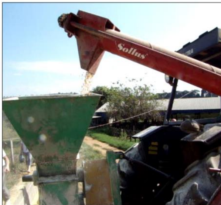
Figura 4 - Moinho acoplado ao 3º ponto do trator agrícola.
