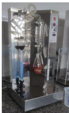
Figura 5- Destilador de Kjeldahl utilizado na determinação de N foliar.
