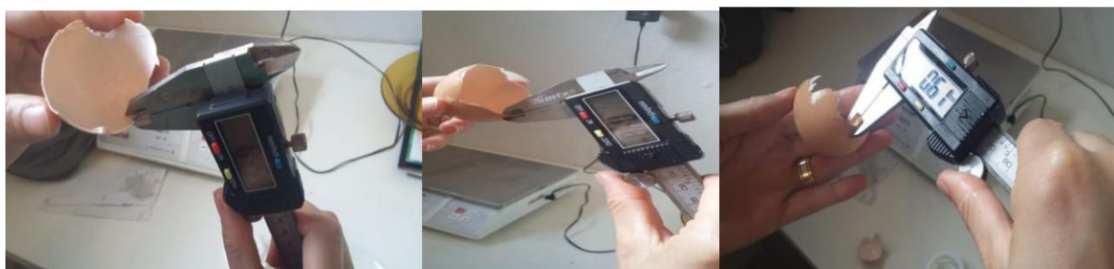
Figura 6: Medição da espessura do ovo com utilização de paquímetro digital da região basal, equatorial e apical.
