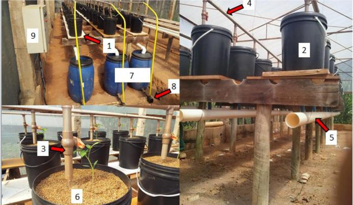
Fonte: o autor. 1 - bancada do experimento; 2 – vaso de 20L; 3 - linha secundária de irrigação com registros de controle de saídas; 4 – linha principal de irrigação; 5 – tubulação de descarga; 6 – substrato de suporte da planta; 7 – reservatório (bombona); 8 – bomba; 9 – painel com temporizadores.
